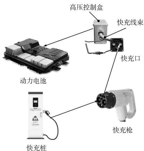
图 1 纯电动汽车直流快充路径示意
